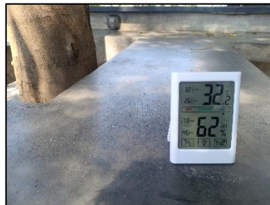
Gambar 2. Hygrometer (Sumber: dokumen pribadi)
