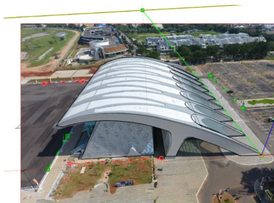
Gambar 16. Rekonstruksi model 3D melalui Photo Match dalam SketchUp (Sumber: Analisis, 2025).
