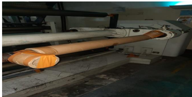
2. Gambar diatas adalah As Shaft Unwinder yang sudah terpasang sempurna core pengganti atau paper core yang dililit oleh tape pada sisi bagian kiri dan kanan
