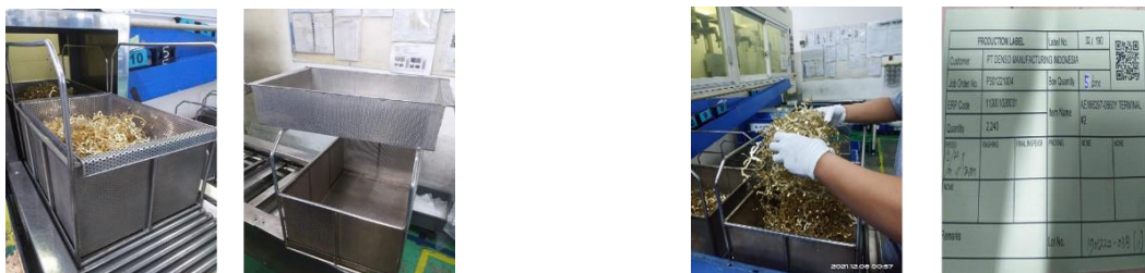
Gambar 9 Proses Pencucian Terminal AE-0660 Sebelum Dan Sesudah Perbaikan
