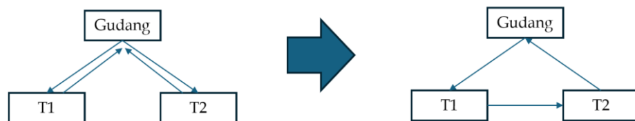
Gambar 2. Perubahan yang terjadi dengan melakukan konsolidasi toko 1 dan toko 2 ke dalam satu rute
