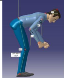
Gambar 7. Pengukuran Sudut REBA
