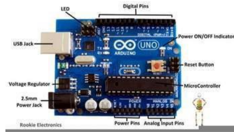
Gambar 1. Arduino Uno
