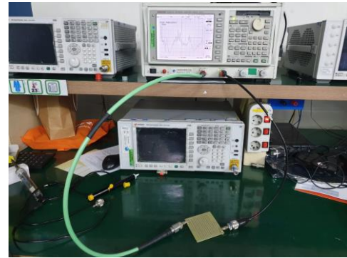
Gambar IV.8. Pengukuran karekeristik Band Pass Filter menggunakan alat ukur Network analyzer
