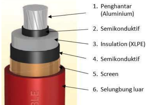
Gambar 2.5. Kabel tanah berinti tunggal Gambar 2.5. yaitu kabel tanah jenis NA2XSY 1x150 cm/25 12/20 ( 24 ) kV menyatakan suatu kabel berinti tunggal, untuk tegangan nominal 12/20 kV, berisolasi XLPE, berpenghantar aluminium dengan luas penampang 150 mm 2 , lapisan tembaga pada bagian luar susunan inti dengan luas penampang 25 mm 2 , dengan selubung PVC. Kabel ini digunakan dalam penelitian ini yang sudah terpasang pada transformator 1 150/20 kV di GIS Gandaria.
