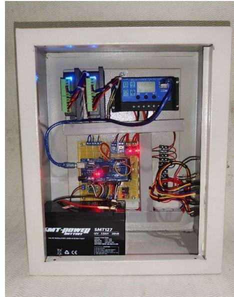
**Gambar 3.6 Rangkaian Elektrik Dual Axis Solar Tracker**
