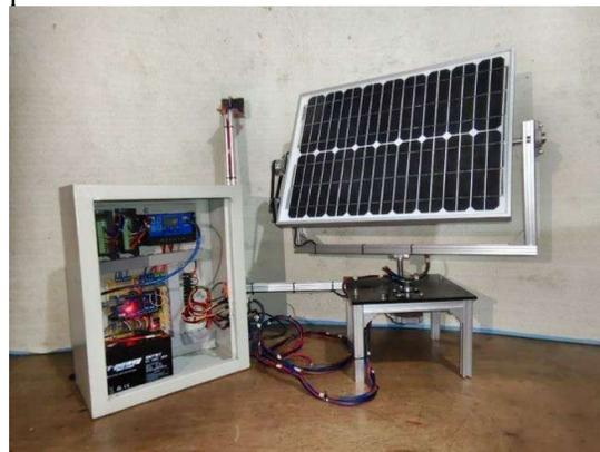
**Gambar 3.7 Rangkaian Keseluruhan Dual Axis Solar Tracker**
