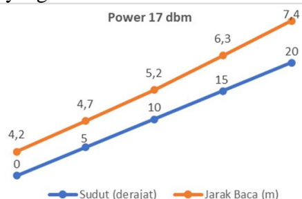
Gambar 4. 2 Grafik Jarak Baca dengan Konfigurasi Power 17 dBm Sumber : Dokumen Penulis
