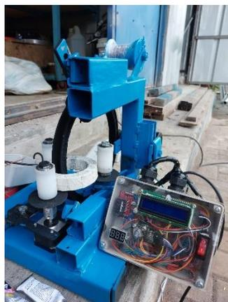
Gambar 3. 6 Alat penggulung lilitan Transformator toroid
