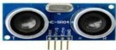
Gambar 2.4 Bentuk Fisik Sensor Ultrasonik
