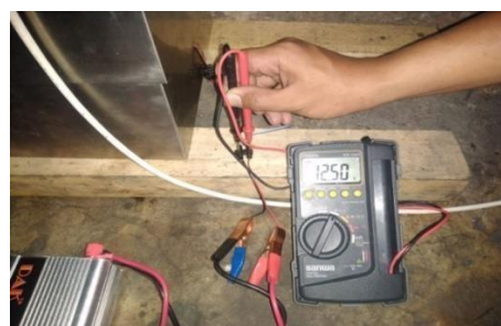
Gambar 3. 1 Tegangan pembangkit sebelum terkoneksi ke inverter
