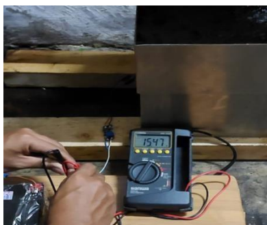
Gambar 3. 2 Tegangan pembangkit pada output modul MT3608
