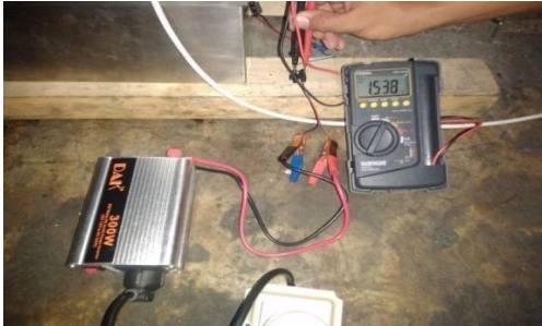
Gambar 3. 2 Tegangan pembangkit setelah terkoneksi dengan inverter
