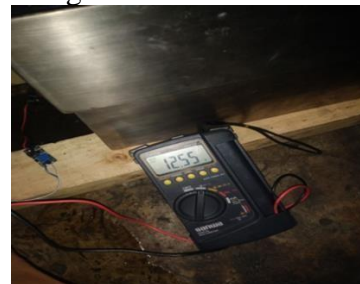
Gambar 3. 3 Pengujian Tegangan Output Pembangkit
