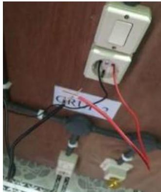
Gambar IV.4.2. 1 Hubungan singkat antara bagian fasa dengan netral pada salah satu grub pembebanan
