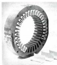
Gambar 2.7 Inti dengan Kertas Isolasi pada beberapa alurnya
