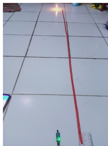
Gambar 3.7 Pengujian sensor api pada jarak 150 cm
