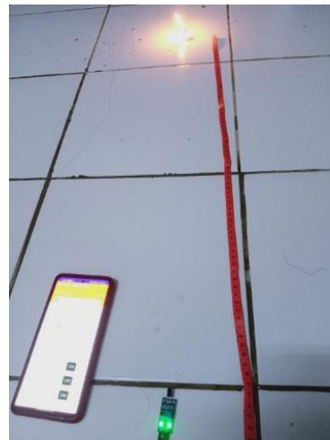
Gambar 3.6 Pengujian sensor api pada jarak 70 cm
