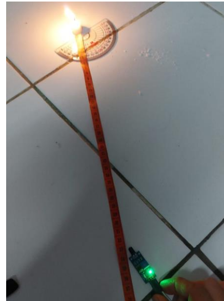
Gambar 3.10 Pengujian sensor api dengan sudut 30°
