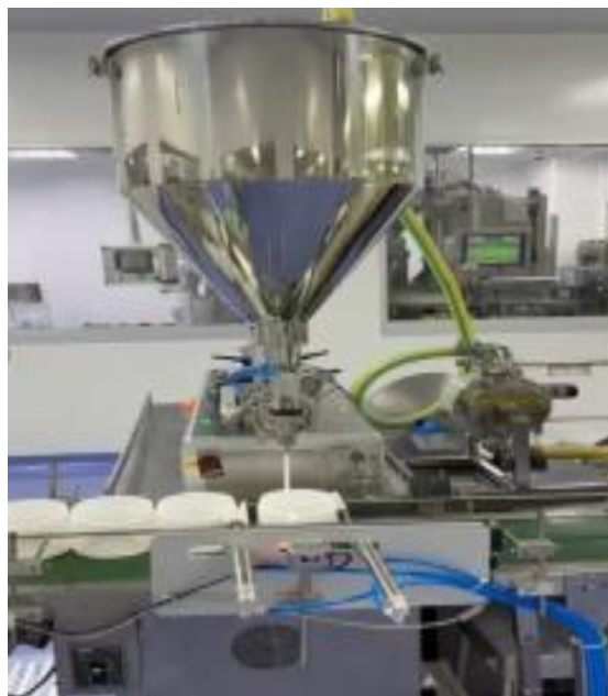
Gambar 8. Mesin Filling Alers PFM type 1624 Sesudah Modifikasi
