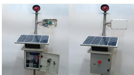
Gambar 6. Realisasi Alat Deteksi Kebakaran
