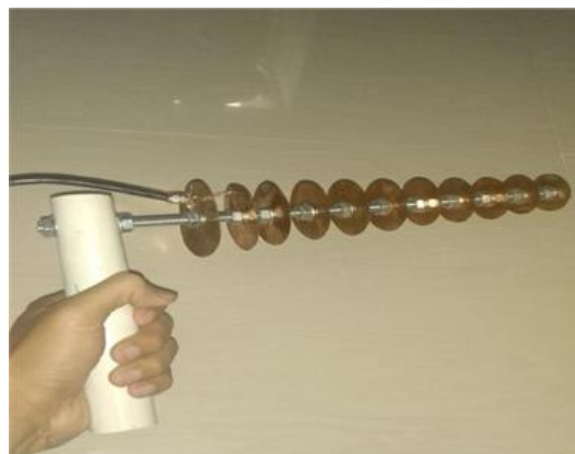
Gambar 4. Bentuk Antena Yagi yang dipabrikasi
