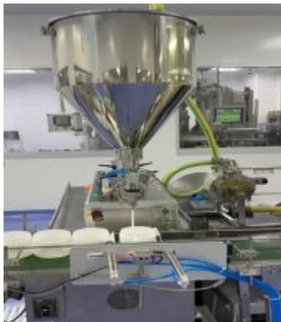
Gambar 8. Mesin Filling Alers PFM type 1624 Sesudah Modifikasi
