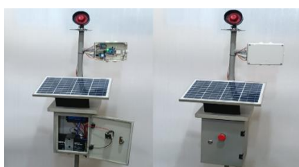
Gambar 6. Realisasi Alat Deteksi Kebakaran
