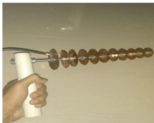
Gambar 4. Bentuk Antena Yagi yang dipabrikasi
