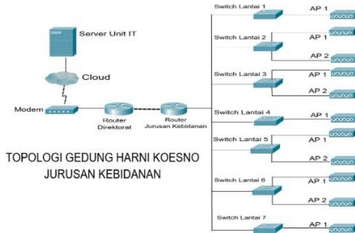
Gambar 3. Topologi Jaringan WLAN Jurusan Kebidanan
