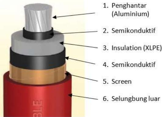
Gambar 2.5. Kabel tanah berinti tunggal Gambar 2.5. yaitu kabel tanah jenis NA2XSY 1x150 cm/25 12/20 ( 24 ) kV menyatakan suatu kabel berinti tunggal, untuk tegangan nominal 12/20 kV, berisolasi XLPE, berpenghantar aluminium dengan luas penampang 150 mm<sup>2</sup>, lapisan tembaga pada bagian luar susunan inti dengan luas penampang 25 mm<sup>2</sup>, dengan selubung PVC. Kabel ini digunakan dalam penelitian ini yang sudah terpasang pada transformator 1 150/20 kV di GIS Gandaria.
