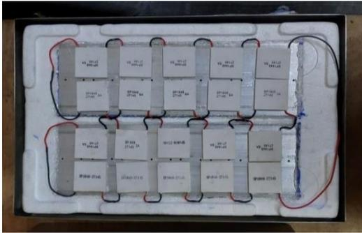
Gambar 3.6 Rangkaian Termoelektrik
