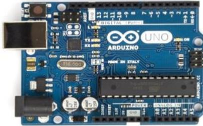
Gambar 2.1 Module Mikrokontroler ATmega 328P
