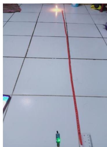
Gambar 3.7 Pengujian sensor api pada jarak 150 cm
