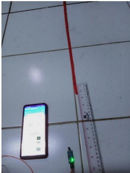
Gambar 3.8 Pengujian sensor api pada jarak 170 cm
