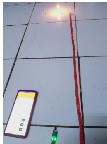
Gambar 3.6 Pengujian sensor api pada jarak 70 cm
