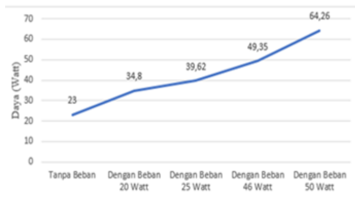
Gambar 8. Karakteristik keluaran daya inverter
