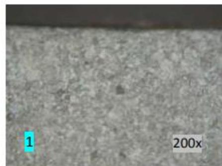
Gambar 17. Mikrograf sampel 3 dari batang piston sepeda motor non-Original. Pembesaran 200x dan Etsa : Nital 2%.
